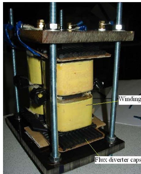
Hình 2. 2. Biến áp với lớp che làm lệch hướng từ thông
